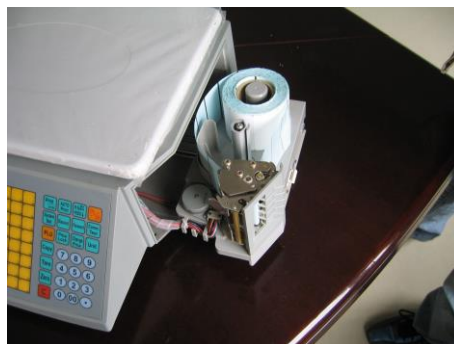
(6) Установите печатающее устройство в исходную позицию
