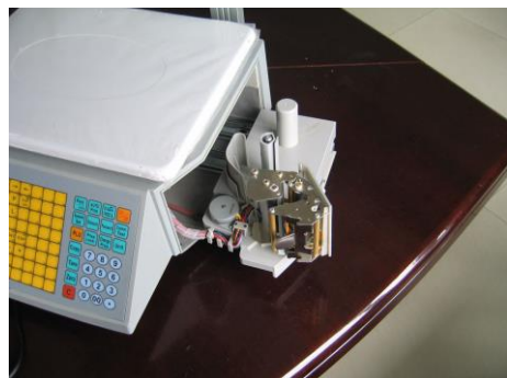
(3) Откройте выдвижное печатающее устройство
